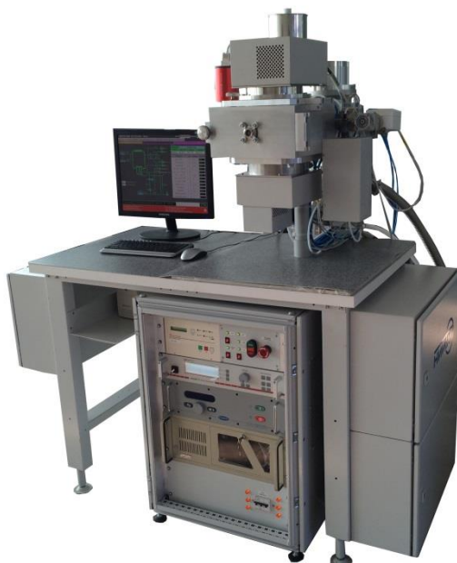
Рисунок 1. Установка глубокого анизотропного травления МВУ ТМ Плазма 06.
